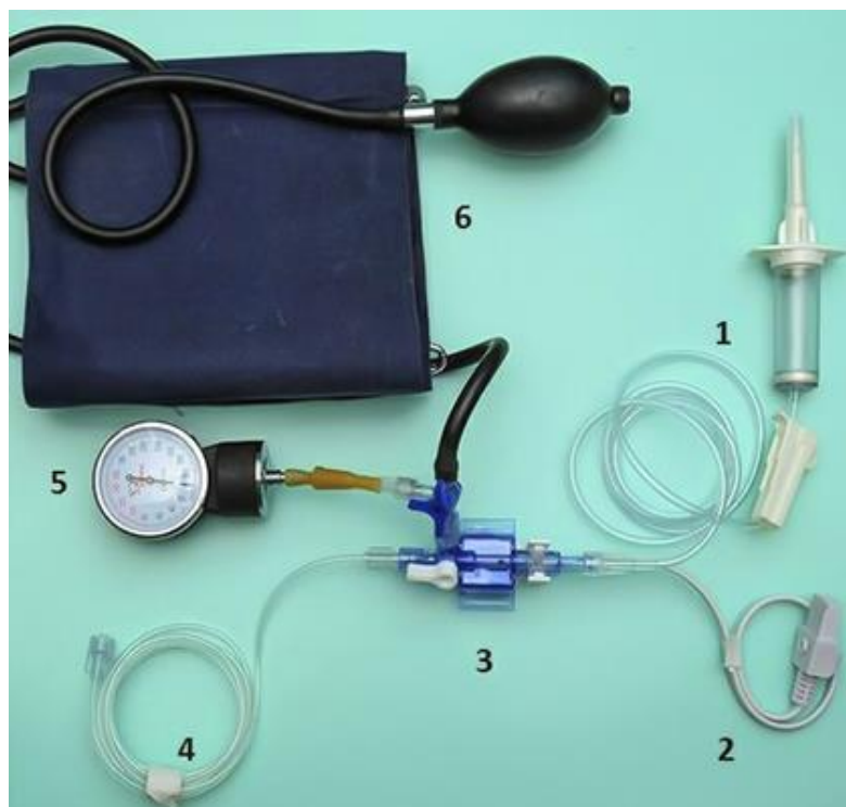
Fig. 1. Vista general del sistema de calibración manométrica. 1. Bolsa presurizada; 2. Conexión del conector al monitor; 3. Transductor de presión; 4. Conexión a la línea arterial; 5. Manómetro; 6. Bolsa inflable.
